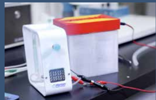
圖 2 許冠南教授研究團隊研發的新型鋅 - 空氣電池模具
